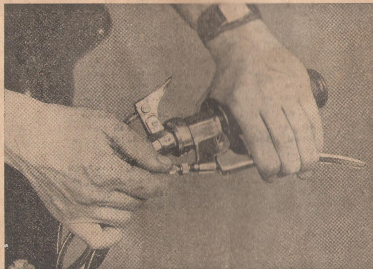
Фиг. 15. Выборка игры троса сцепления.
